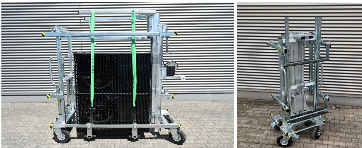
Der Wärmepumpenlift stellt somit eine innovative Lösung dar, die sowohl die Effizienz als auch die Sicherheit bei der Installation von Wärmepumpen-Außeneinheiten erheblich verbessert
